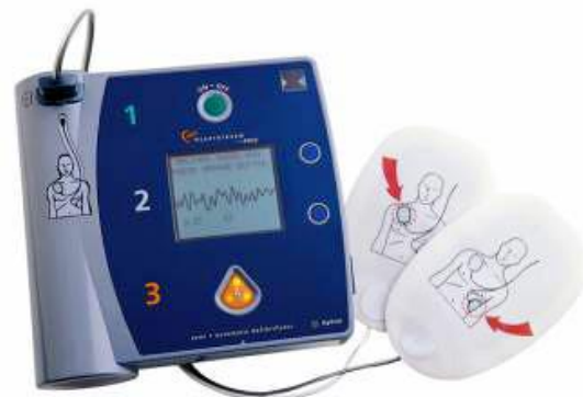
Slika 2. Automatski spoljašnji defibrilator (AED)
